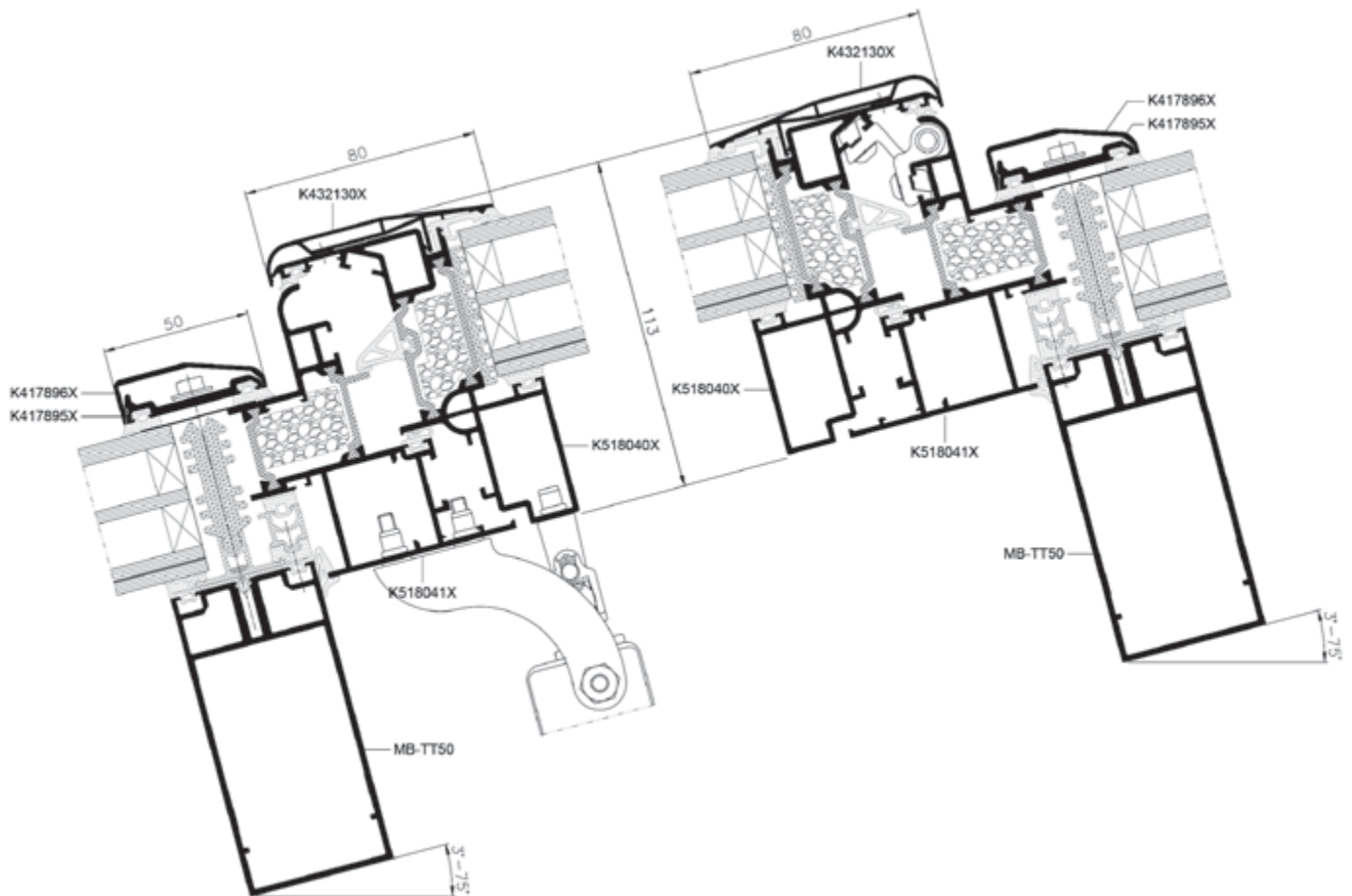
Fenêtre d'évacuation de fumées du système MB-RW en toit vitré du système MB-TT50, vue en coupe
